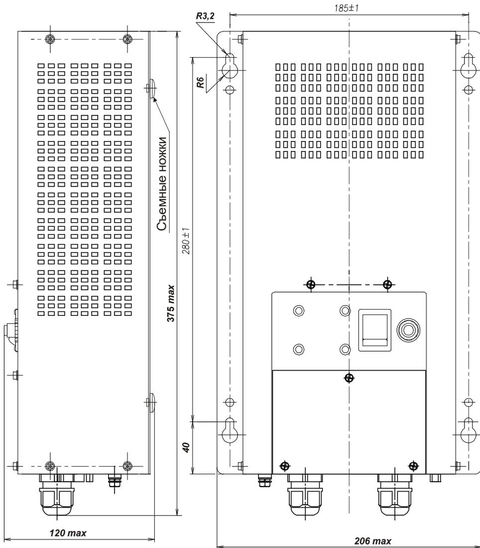
Рисунок А.1 – Габаритные и установочные размеры стабилизатора
