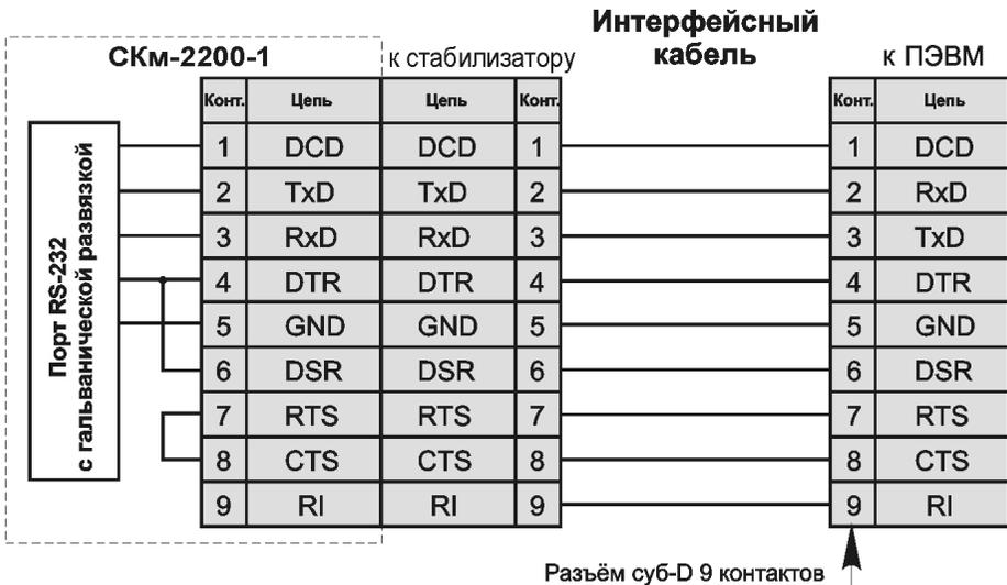
Рисунок 6 – Схема электрическая соединения стабилизатора с ПЭВМ
