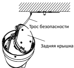
Рисунок 2-7 Крепление камеры к монтажной платформе
